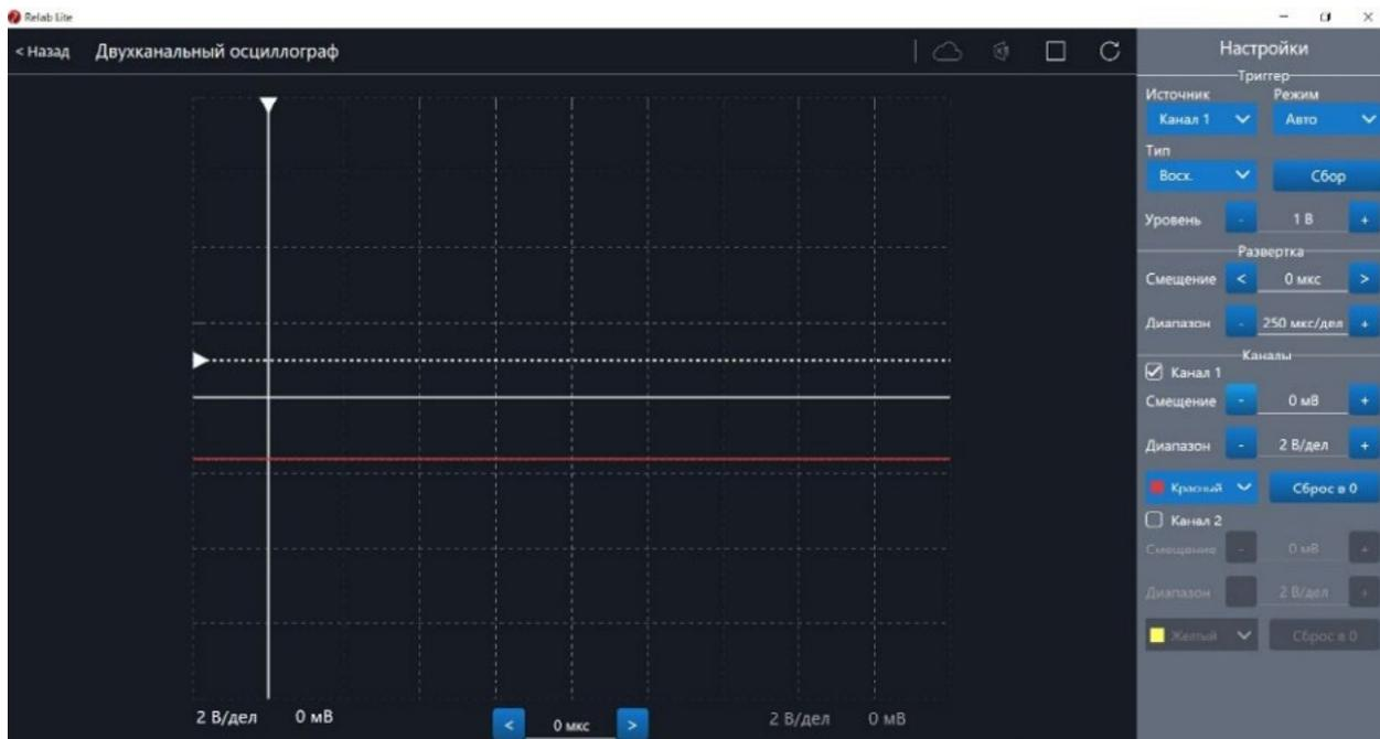
Рис. 40. Сигнал с ненулевым смещением
