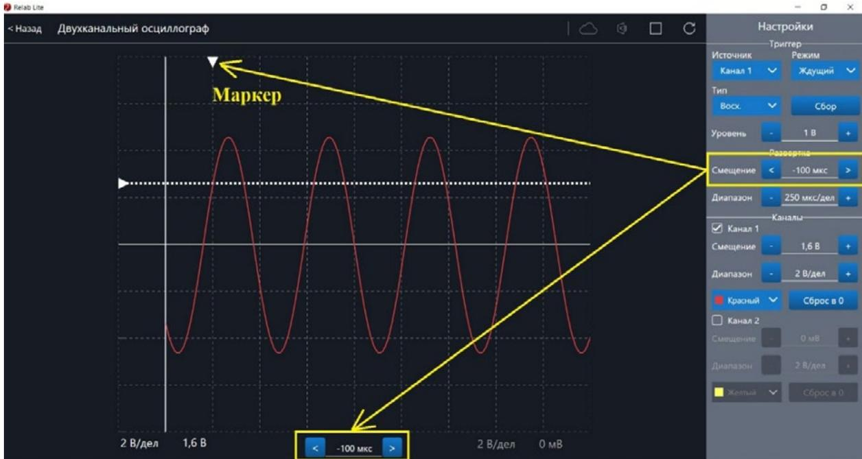
Рис. 38. Использование параметра **Смещение** в блоке **Развёртка**
