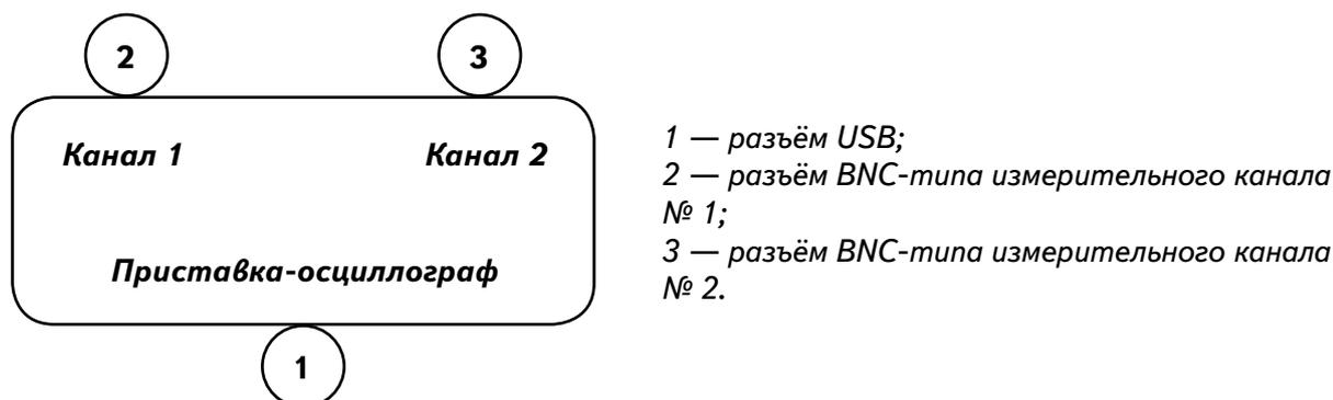
Рис. 33. Схема приставки-осциллографа
