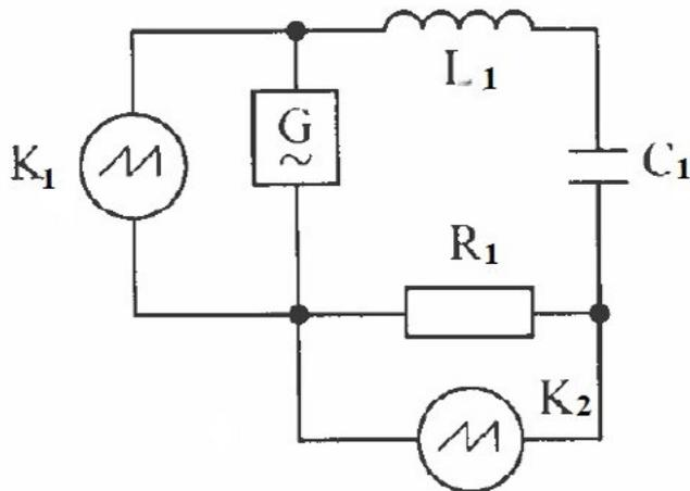
**Схема электрической цепи:**  $G$  — звуковой генератор,  $K_1$  — первый канал осциллографа,  $K_2$  — второй канал осциллографа,  $R_1$  — резистор для измерения тока,  $C_1$  — конденсатор,  $L_1$  — катушка индуктивности
