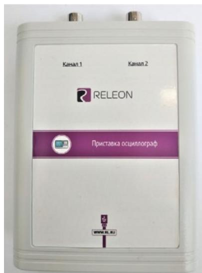
Рис. 32. Двухканальная приставка-осциллограф
