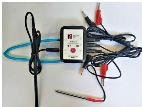
Рис. 9. Беспроводной мультидатчик Releon Air «Физика-5»
