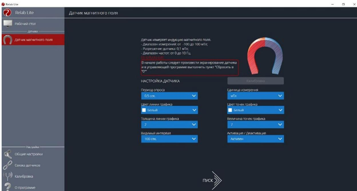
Рис. 22. Информация о датчике и особенностях его использования
