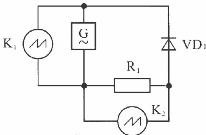
**Рис. 2.** Схема электрической цепи:  $G$  — звуковой генератор,  $K_1$  — первый канал осциллографа,  $K_2$  — второй канал осциллографа,  $R_1$  — резистор для измерения тока,  $VD_1$  — полупроводниковый диод
