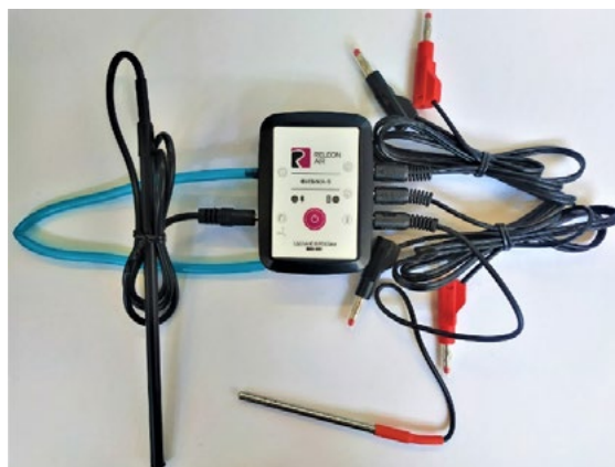
Рис. 9. Беспроводной мультидатчик Releon Air «Физика-5»
