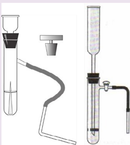
Рис. 7. Прибор для получения и собирания газов
