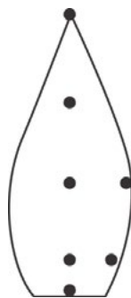
Рис. 1. Точки измерения температуры пламени
