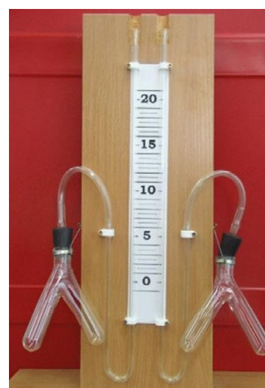
Рис. 11. Прибор для определения скорости химических реакций
