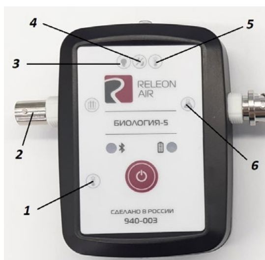
Рис. 2. Мультидатчик по биологии: 1 — температура растворов, 2 — электропроводимость, 3 — освещённость, 4 — относительная влажность воздуха, 5 — температура окружающей среды, 6 — pH
